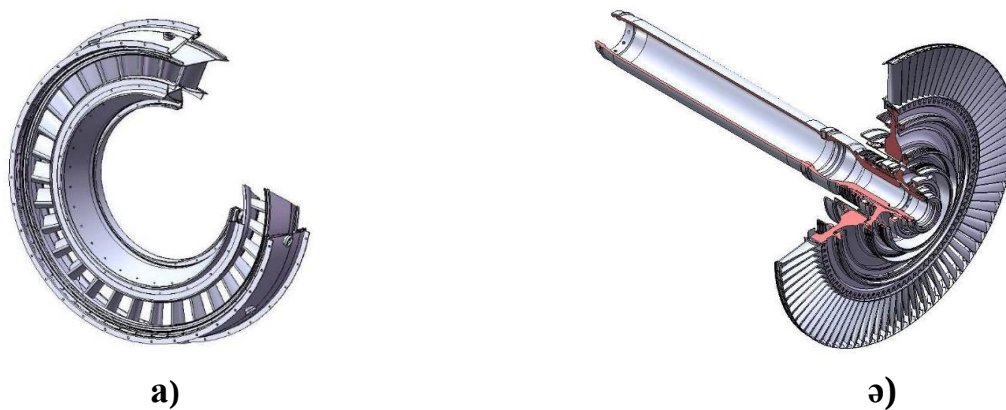
5 сурет – а - статор, ә - ротор
